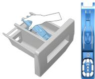
Регулярно очищайте распределитель моющих средств (каждые 4-5 циклов стирки), чтобы избежать отложений стирального порошка. Поднимите заднюю часть сифона, чтобы его вынуть, как показано на рисунке.
