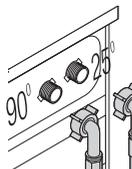
Подсоедините специальные водопроводные шланги, которые входят в комплект, к водоприемным патрубкам стиральной машины. Красный шланг (слева) (макс. 90 °C) подсоединяется к патрубку для горячей воды, а синий (справа) (макс. 25 °C) – к патрубку для холодной воды.
